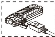
2. Индикатор зарядки: встроенный в фонарь индикатор заряда батареи будет непрерывно гореть в процессе зарядки, и погаснет после полной зарядки Tube RL.
